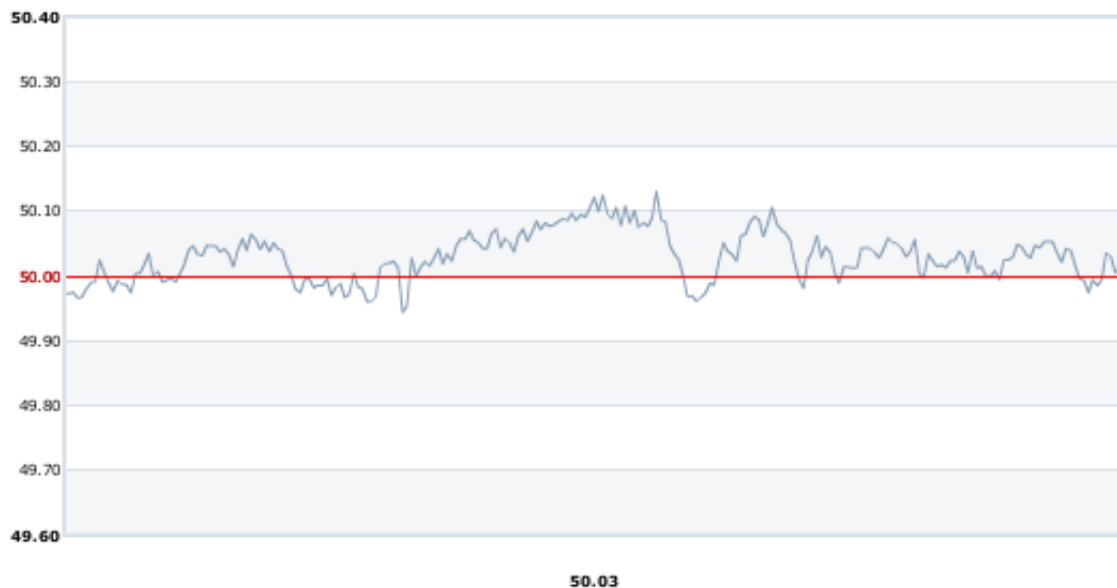
FIGURE 3 – La fréquence sur un grand réseau interconnecté est très stable (fréquence en Hz du réseau National Grid le 30/08/2013 observée sur une période d'une heure – source National Grid).
